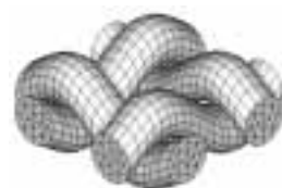
6.B. Tessuto monofilamento: modello ad elementi finiti
