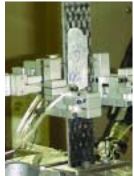
4. prova di trazione strumentata con estensimetro biassiale
