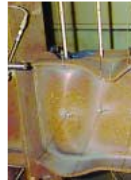
1. Particolare di nodo trave-colonna in acciaio sottoposto a storie di carico di tipo sismico
