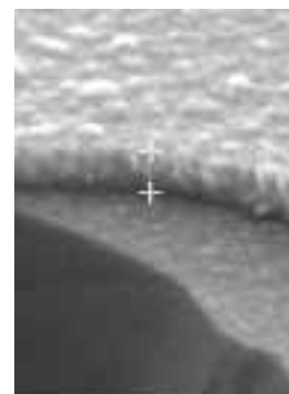
6. Immagine SEM della sezione di rame elettrodeposto dopo 2h (spessore 200 nm). 1.00 mm
