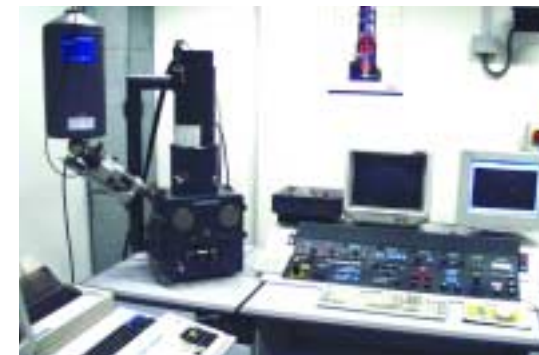
6. Microscopio elettronico a scansione per l'analisi ad elevati ingrandimenti dei materiali per applicazioni meccaniche
