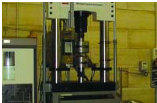
5. Macchina per prove statiche e a fatica in condizioni di sollecitazione multiassiale (in alto) in condizioni di sollecitazione semplici (in basso).
