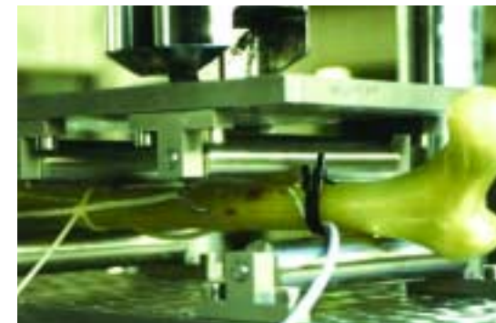
1. Misura della proprietà meccaniche di un modello di femore umano in composito polimerico
