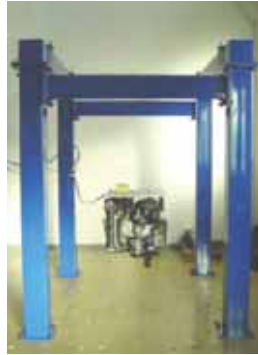
2. Il dispositivo per le misure su piccole masse The system for small mass measurements
