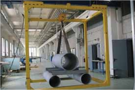
1. Il dispositivo per le misure su grandi masse The system for huge mass measurements
